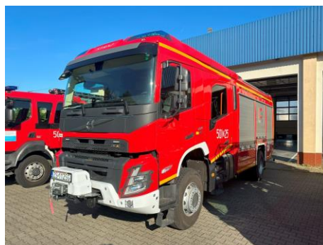
Rys. 6. Ciężki samochód ratowniczo-gaśniczy ze zwiększonym potencjałem ratownictwa drogowego z napędem uterenowionym 4x4
