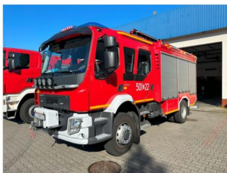
Rys. 5. Średni samochód ratowniczo-gaśniczy z systemem piany sprężonej z napędem uterenowionym 4x4
